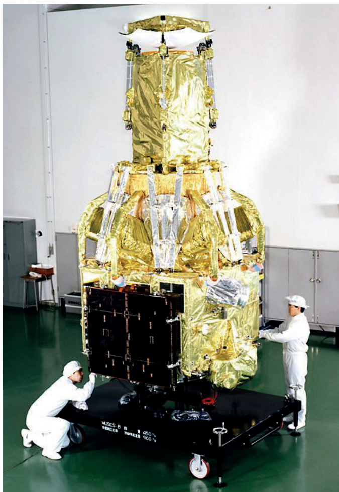
Fig. 3. In questa fotografia due tecnici stanno eseguendo l'assemblaggio finale o i controlli su HALCA, il satellite centrale del progetto VSOP. La lamina dorata che ricopre il satellite funge da isolante termico, essenziale per mantenere i delicati strumenti a bordo operativi nonostante le estreme variazioni di temperatura nello spazio. Credits: Institute of Space and Astronomical Science - Japan Aerospace Exploration Agency
