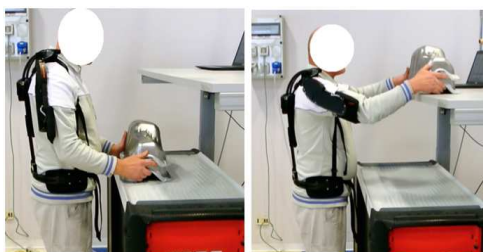
Fig.3 – Istantanee prova dinamica con esoscheletro
