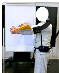
Fig.2 – Istantanea prova statica con esoscheletro
