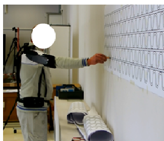
Fig.4 – Istantanea prova di precisione con esoscheletro
