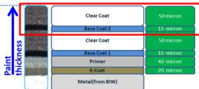
Figura 1 – Scocca tristrato definita per il processo di verniciatura
