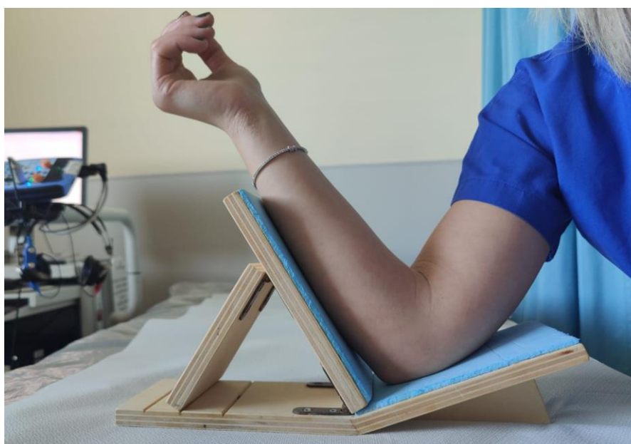
Figura 2. Posizionamento del braccio sul Goniometro ulnare
