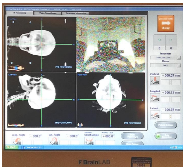
Figura 9: Posizionamento dei target all'isocentro tramite lo schermo BrainLAB presente nel bunker
