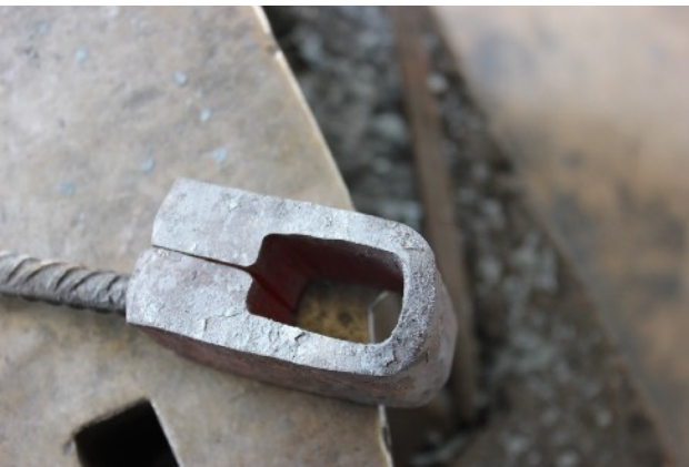
Figura 11: L'occhio chiuso e pronto per la saldatura.
