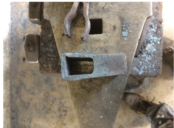
Figura 12: Particolare dell'occhio saldato.
