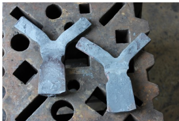
Figura 3: Due scuri in lavorazione col metodo utilizzato in prima ipotesi, rivelatosi non adatto allo scopo.
