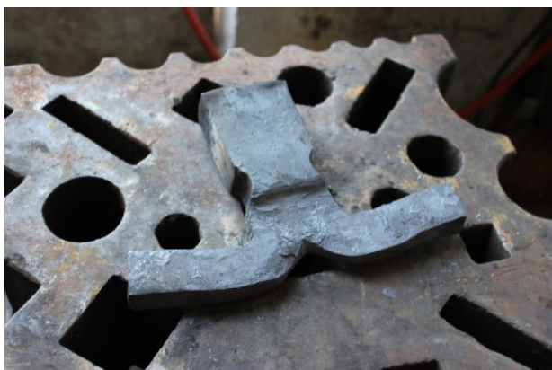
Figura 4: In questo semilavorato si può notare la complessità del processo tentato per ottenere una lama con l'occhio da un unico pezzo.
