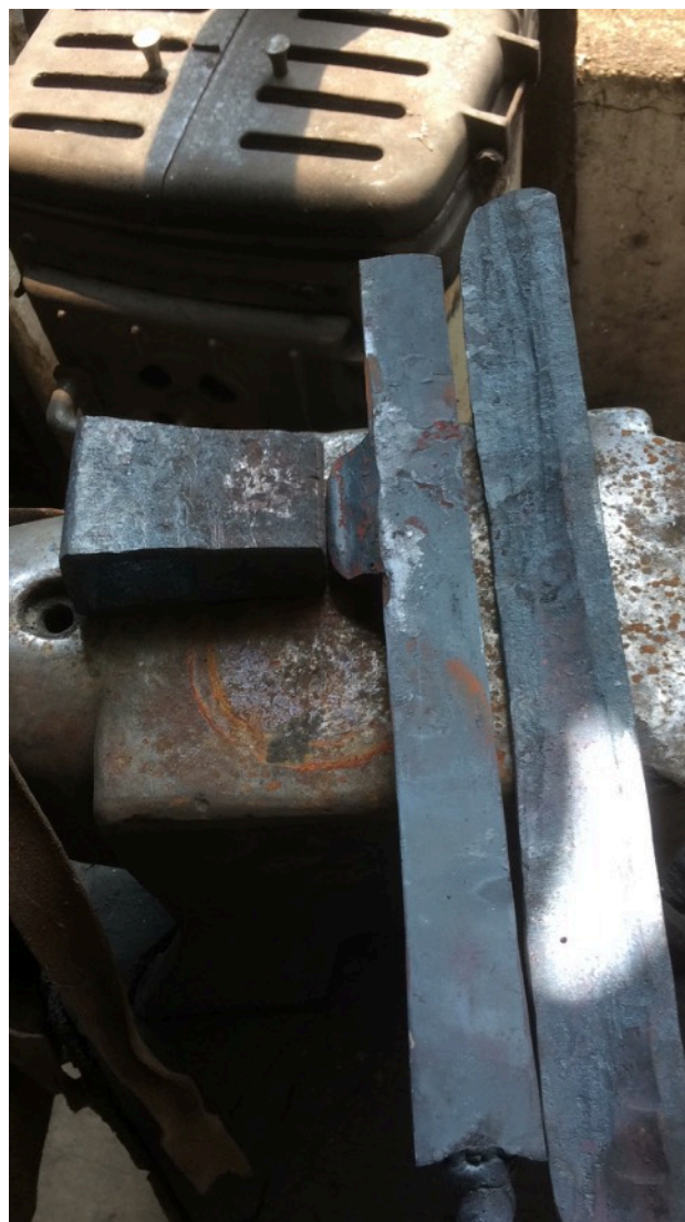
Figura 6: Sono qui visibili i tre componenti della scure: occhio (a sinistra), lama (al centro) e filo (a destra).
