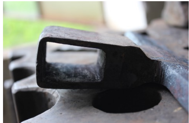
Figura 16: L'occhio rifinito dopo la saldatura della lama; si può notare l'evidente disassamento.
