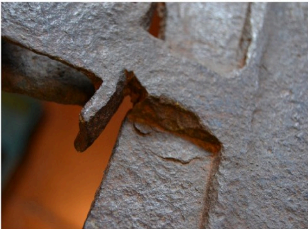
Figura 10: Linee di saldatura della stessa tipologia, molto più evidenti, su di una scure 'dolaora' di fabbricazione più recente rispetto all'originale replicata.
