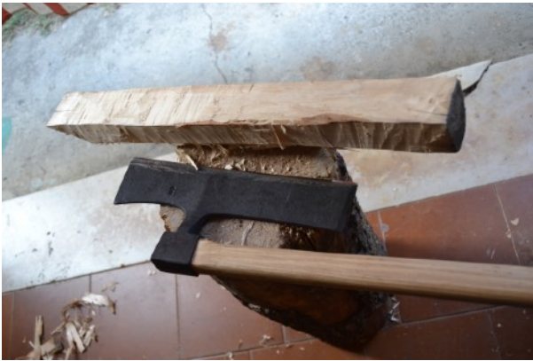
Figura 27: Il piccolo moralétto realizzato a mano. Su tutte le superfici si possono notare i segni di lavorazione lasciati dalla scure da squadro, più pesante della nostra replica, utilizzata inizialmente per ottenere il pezzo. A destra, nella superficie volta verso l'alto, si può apprezzare il risultato di rifinitura ottenuto con la nostra replica.
