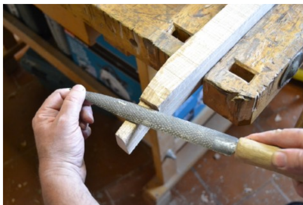
Figura 25: Realizzazione dell'innesto del manico. Nell'immagine si può vedere la curvatura delle fibre che permetterà di ottenere un manico leggermente inclinato rispetto all'asse della testa.
