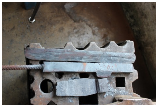
Figura 14: Si possono qui notare sulla lama e sul filo (in alto) le porzioni a sezione triangolare per agevolare la saldatura tra le parti.
