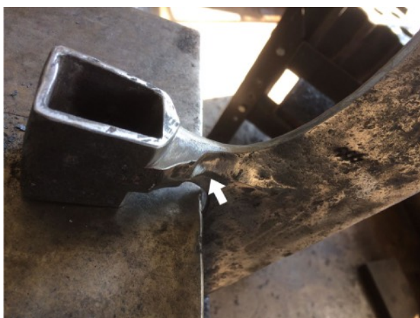
Figura 5: Nonostante le difficoltà il lavoro è stato completato: si osservi la forma finale non congrua dovuta dalla mancanza di spessore tra occhio e lama, come indicato dalla freccia.
