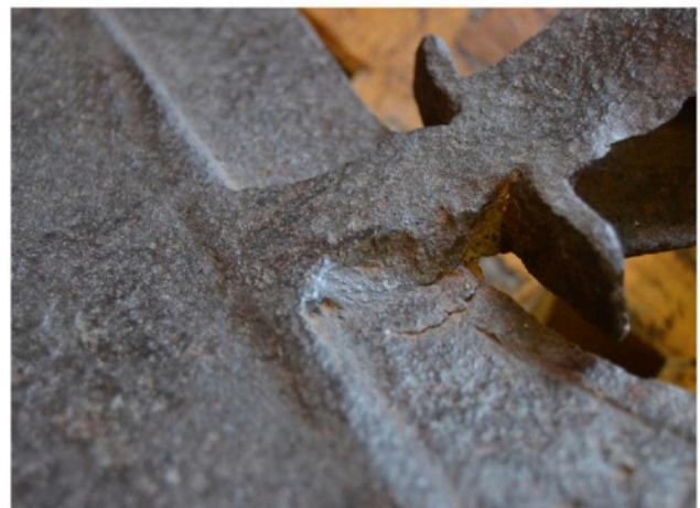
Figura 10: Linee di saldatura della stessa tipologia, molto più evidenti, su di una scure 'dolaora' di fabbricazione più recente rispetto all'originale replicata.
