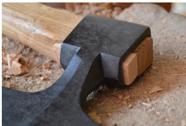
Figura 26: Particolare dell'occhio e del cuneo che permette di fissare il manico.
