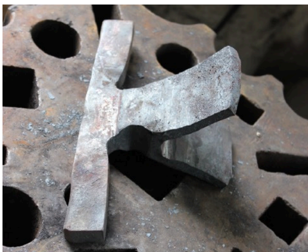
Figura 5: Nonostante le difficoltà il lavoro è stato completato: si osservi la forma finale non congrua dovuta dalla mancanza di spessore tra occhio e lama, come indicato dalla freccia.
