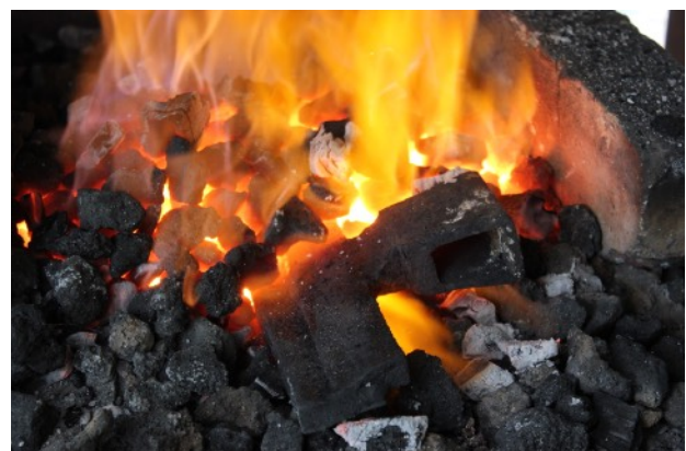
Figura 17: Fase di saldatura del filo della lama.
