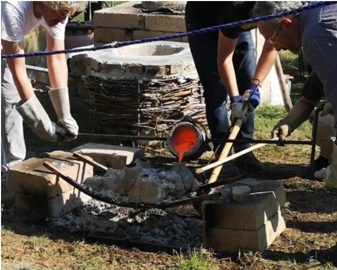
Figura 22: Colata del bronzo saldante.
