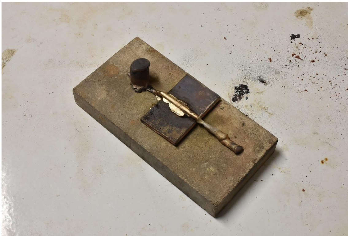
Figura 4: Il getto sembra aver saldato i provini.
