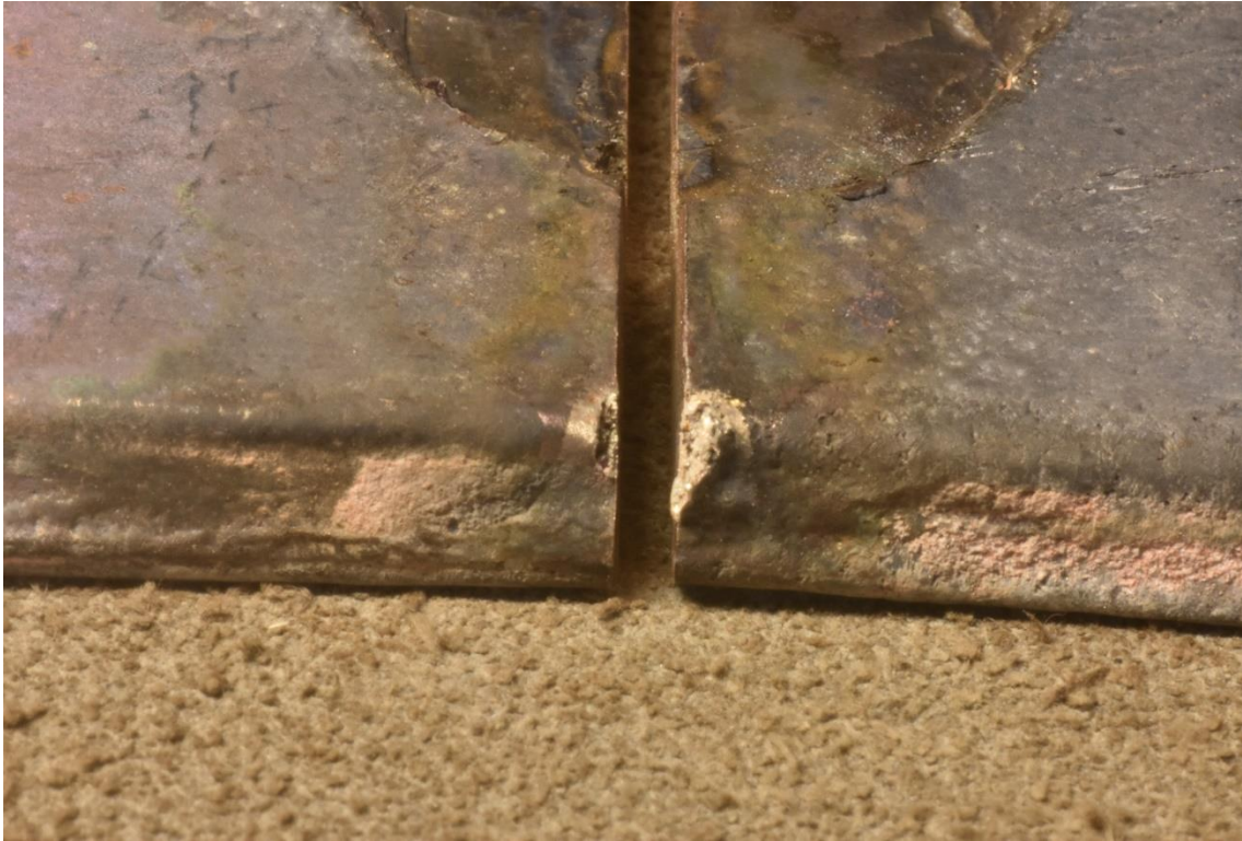
Figura 6: C'è stata solo una minima saldatura in un piccolo punto.
