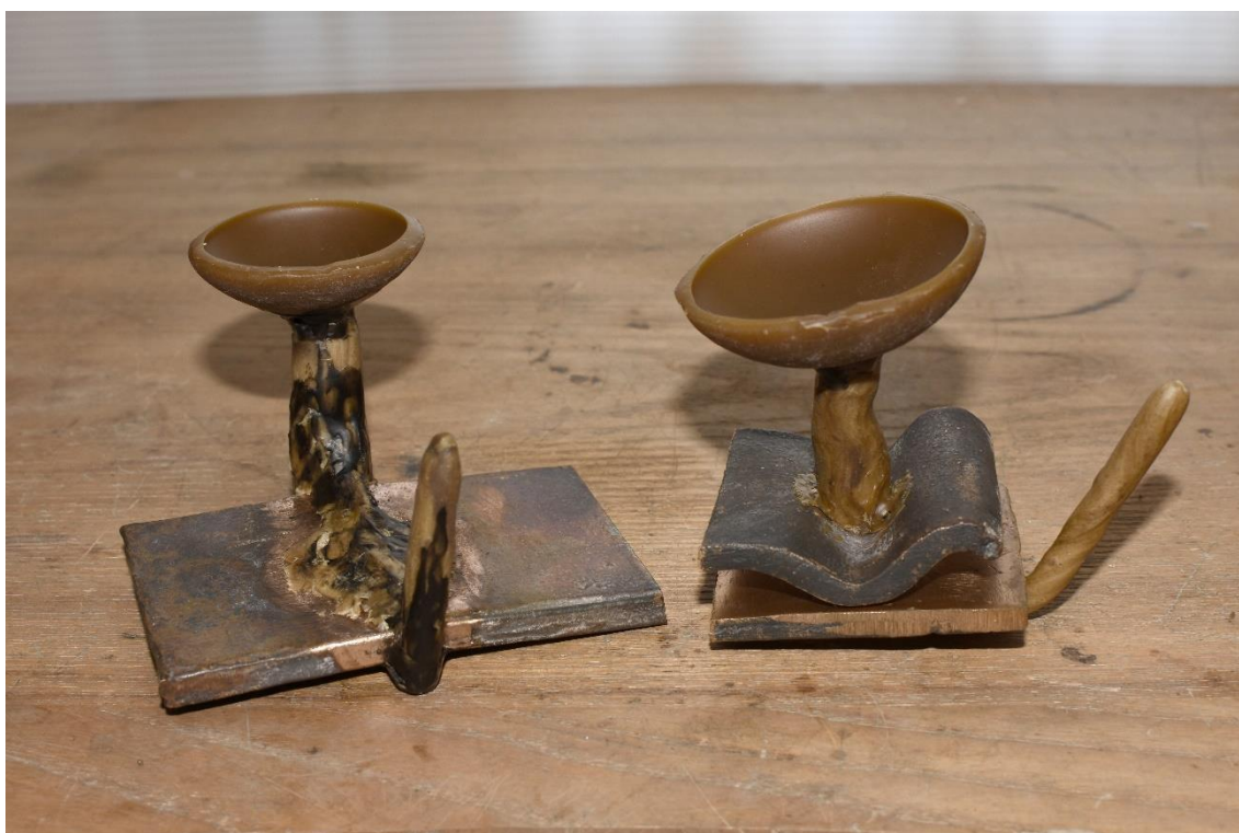
Figura 9: Applicazione della cera d'api: coni e canali di colata.
