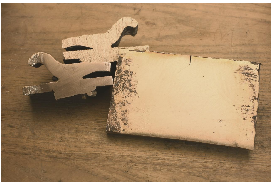
Figura 13: Le sezioni dei provini sembrano dimostrare l'avvenuta saldatura.
