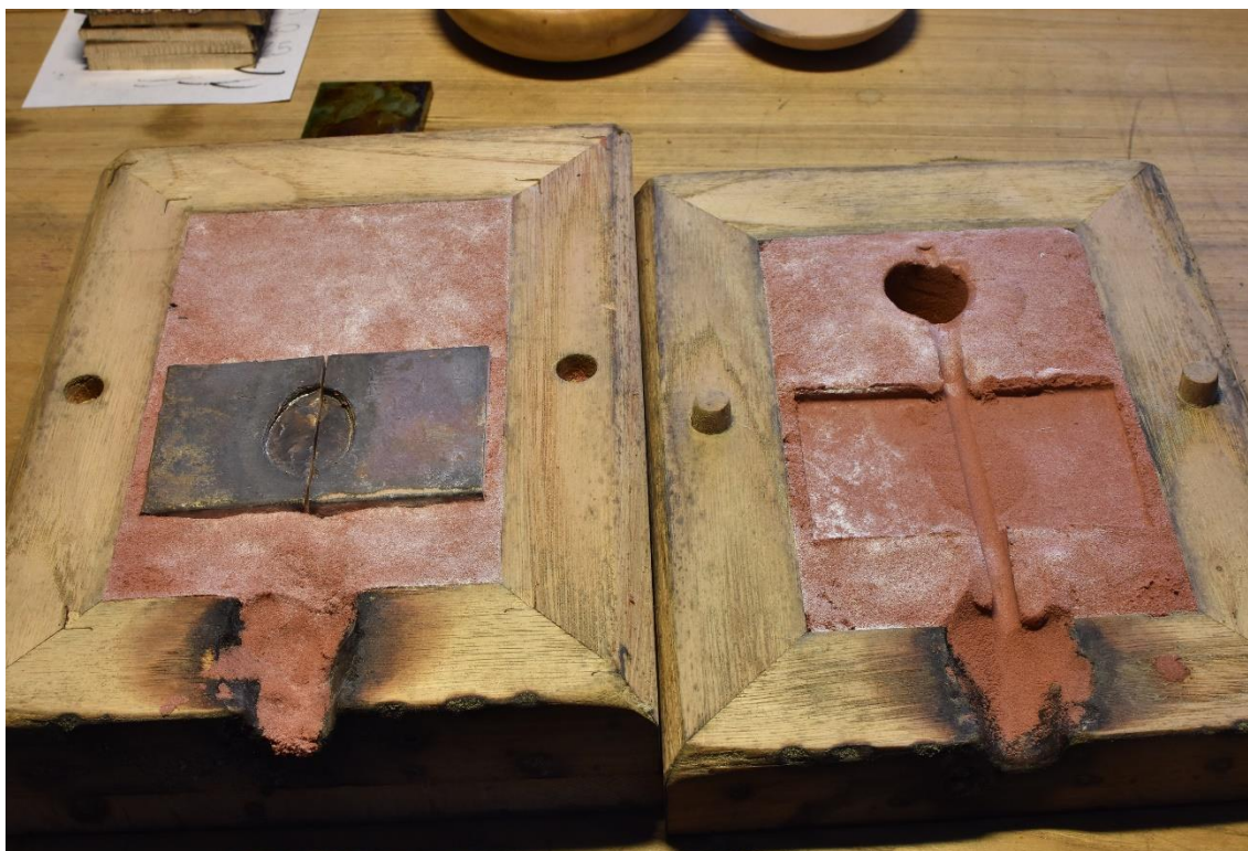
Figura 2: Impressione del provino nella sabbia da fonderia.
