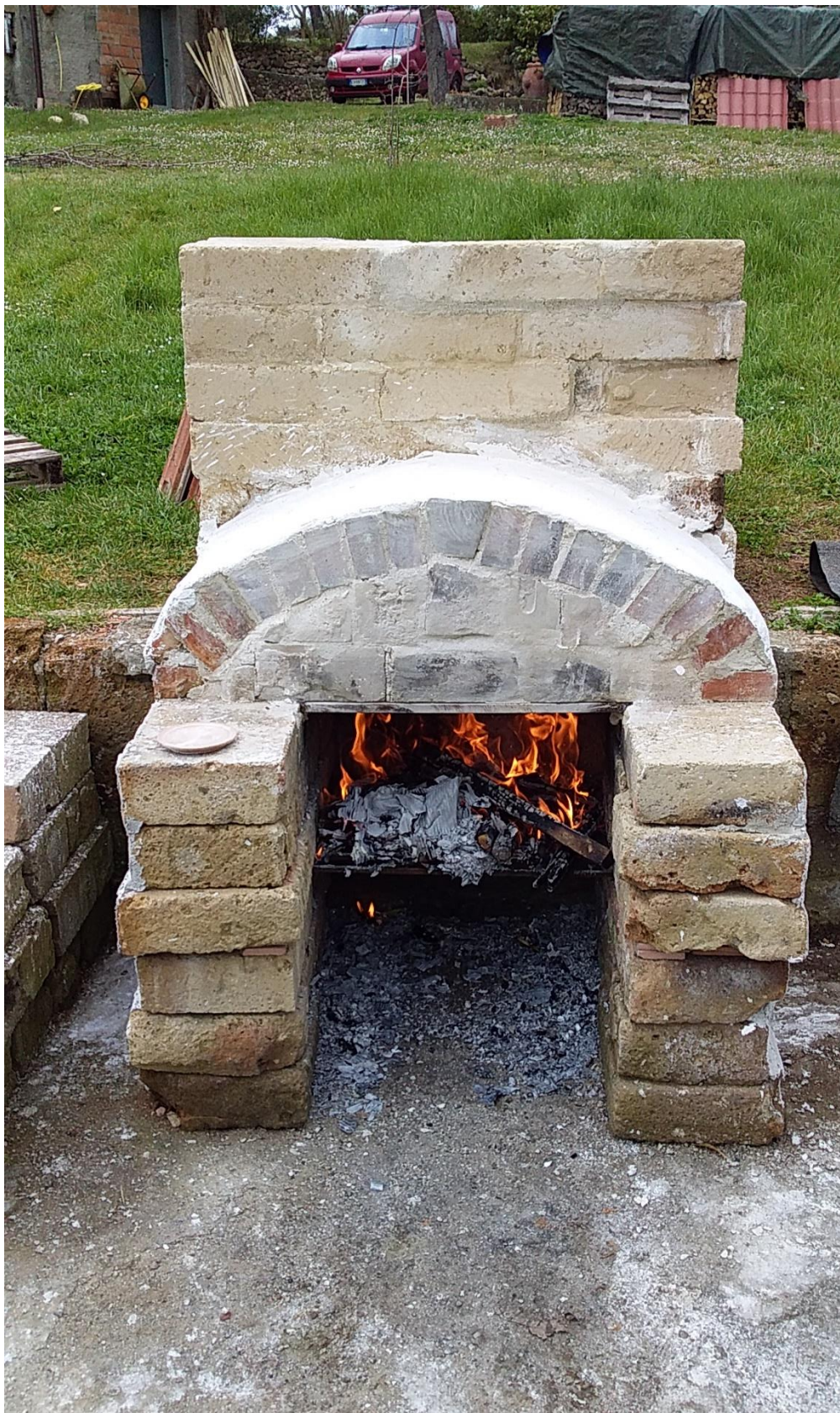
Figura 15: Fornace a tiraggio verticale in fase di accensione.
