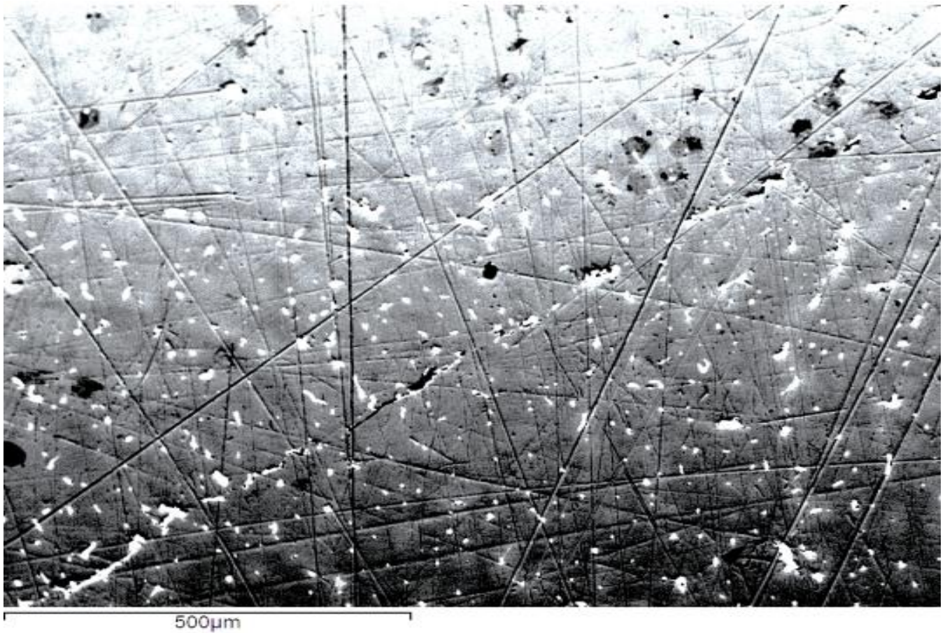
Figura 33: Provino di saldatura passante A di fig. 24, immagine al SEM in BSE
