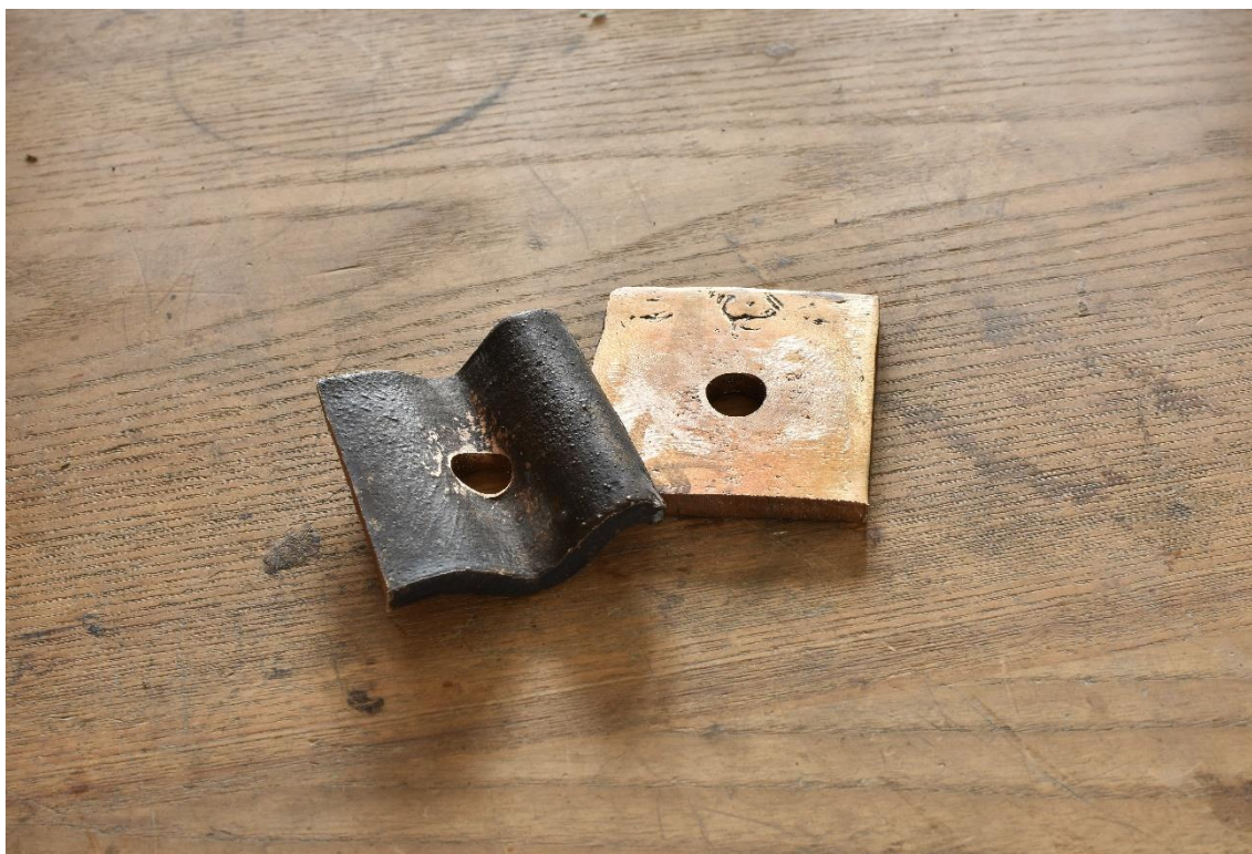
Figura 8: Prova di saldatura passante tra due provini sovrapposti.
