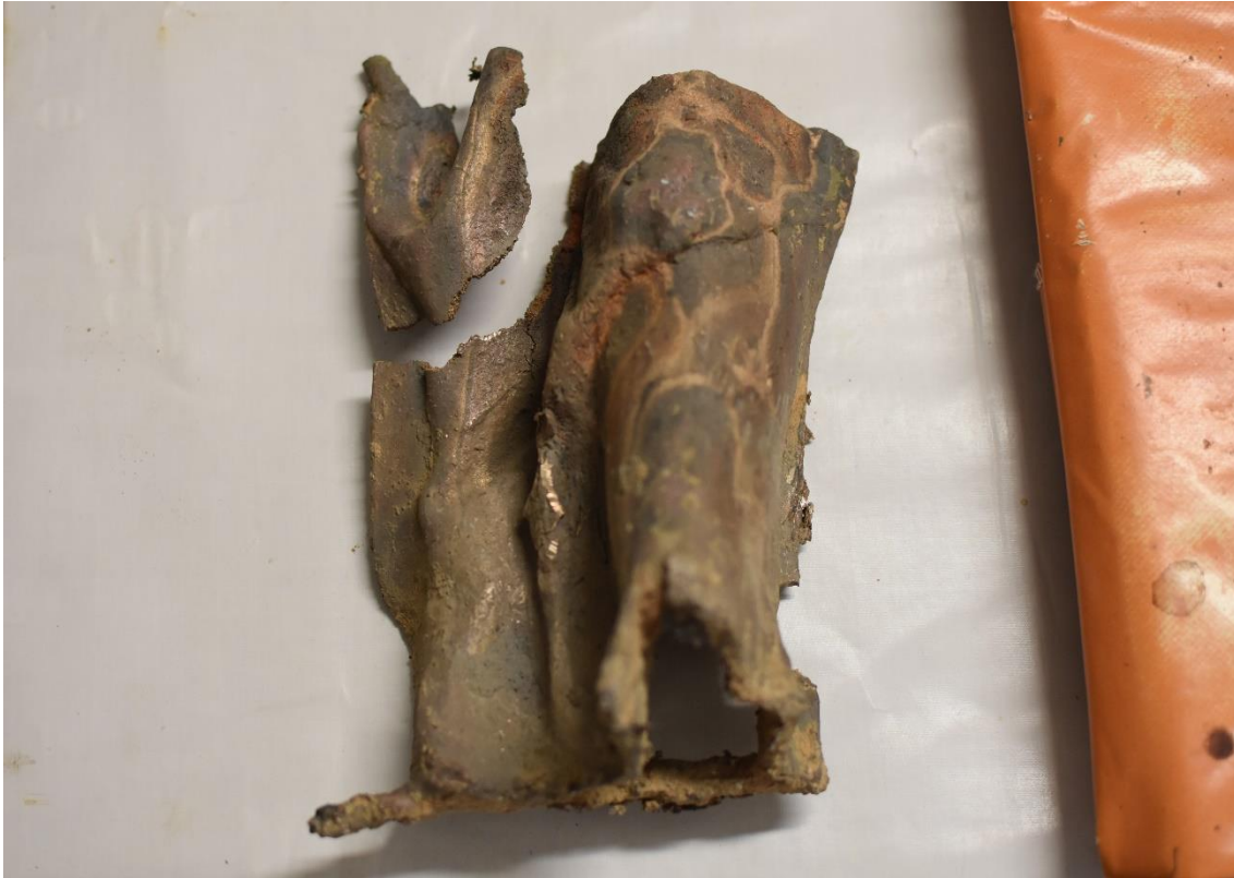
Figura 18: Una sezione della statuetta dopo il getto. La frattura è dovuta a sollecitazione meccanica a caldo.
