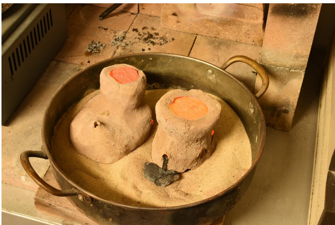
Figura 11: Getto del bronzo saldante nelle forme calde.
