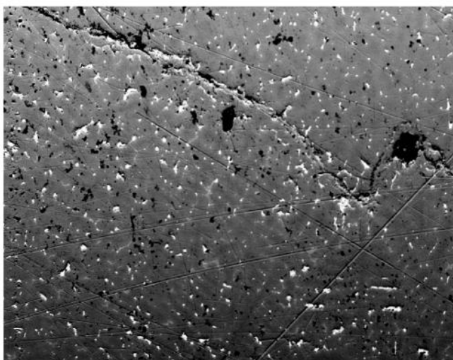
Figura 32: Provino di saldatura passante A di fig. 24, immagini al SEM in BSE. Nell'immagine di sinistra il metallo dell'elemento di pannello è in alto e quello della saldatura è in basso, nell'immagine di destra il metallo di saldatura è nella parte alta, mentre quello del pannello è in basso.
