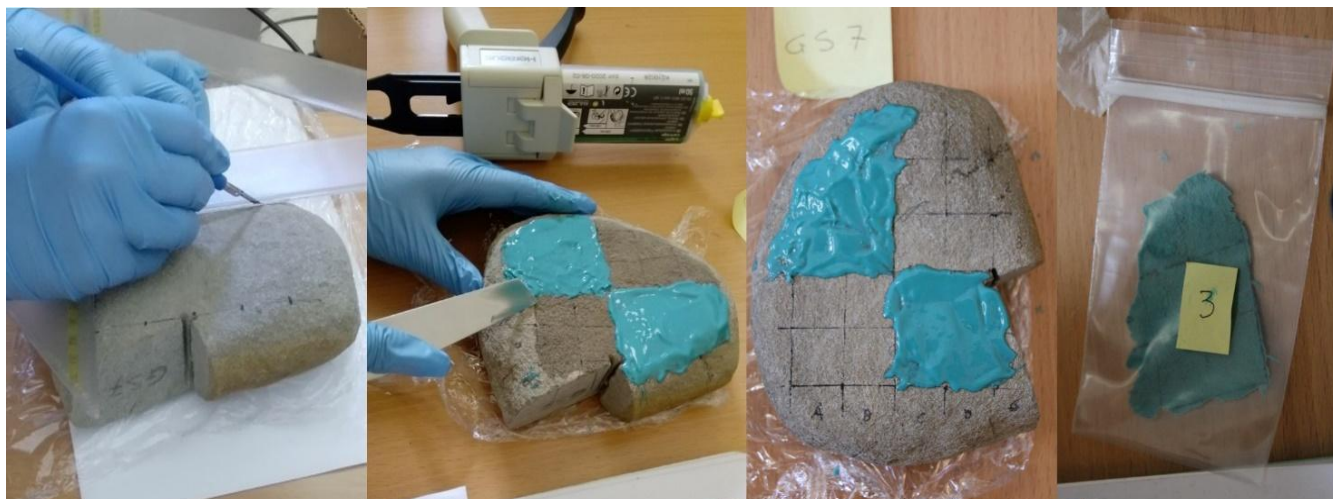
Figura 4: Da sinistra a destra: La faccia d'uso della pietra viene suddivisa in una griglia di 2x2 cm. Impronte, ottenute con il PVS, rappresentative di vari stati di modificazione della superficie della pietra vengono presi ai tempi T_0 , T_1 , T_2 , T_3 , T_4 , e copiando, dove possibile, 4 quadrati in ogni calco ( 16 \text{ cm}^2 ) per le macine mentre per pestelli e macinelli la superficie calcata è variabile a seconda della dimensione e della morfologia del ciottolo. Le impronte vengono riposte in un sacchetto zip e conservate in frigorifero.
