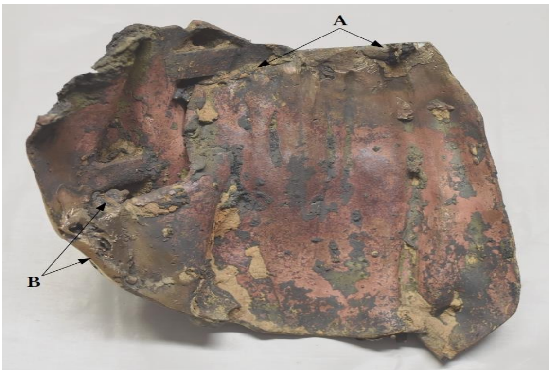
Figura 24: Le saldature uniscono due sezioni della statuetta in due differenti punti (A e B).
