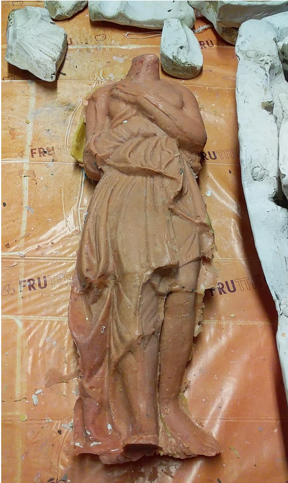
Figura 14: Parte frontale di una statuette in cera ricavata da stampi in gesso per le prove di saldatura.
