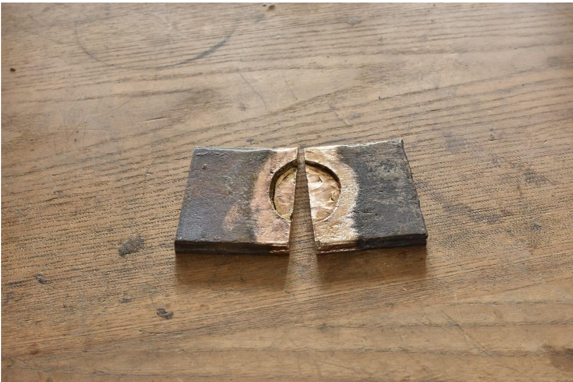
Figura 7: Prova di saldatura a vaschetta.
