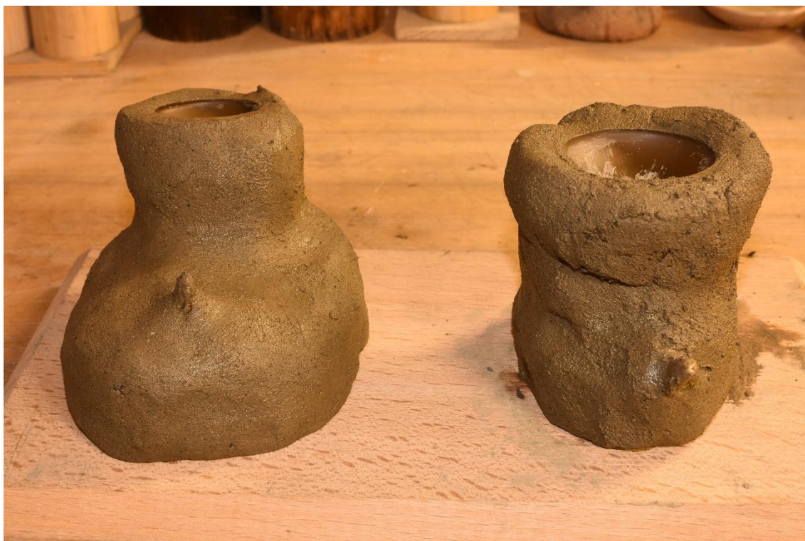
Figura 10: Rivestimento con luto di tipo antico.
