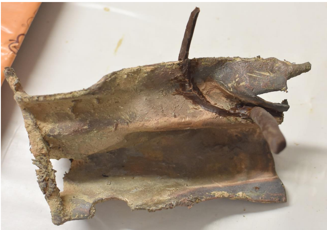
Figura 19: Prova di saldatura per riparare la frattura.
