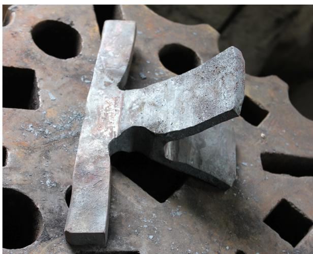
Figura 7 (a sinistra): Lavorazione dell'occhio in uno dei primi tentativi. In questo caso si prevedeva di chiuderlo e saldarlo sul retro.
