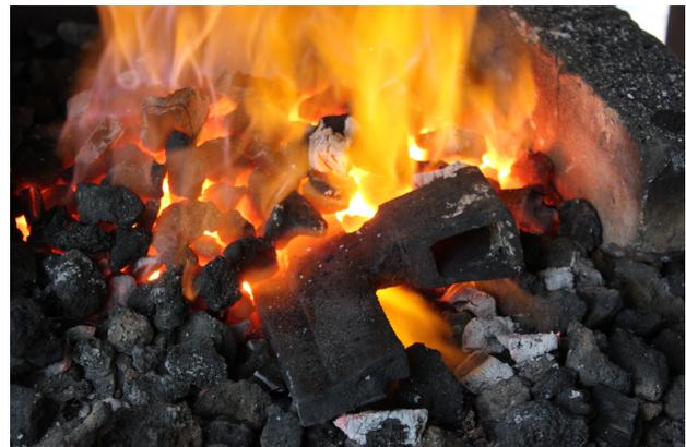
Figura 17: Fase di saldatura del filo della lama.
