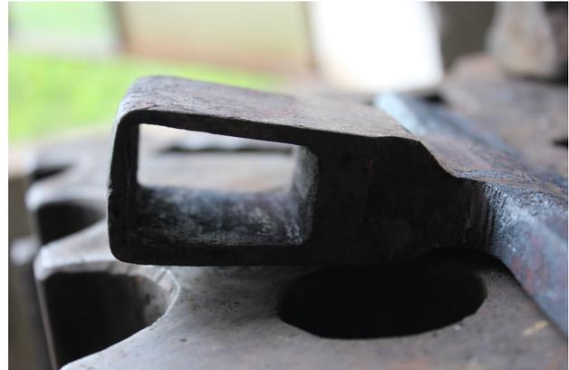
Figura 16: L'occhio rifinito dopo la saldatura della lama; si può notare l'evidente disassamento.
