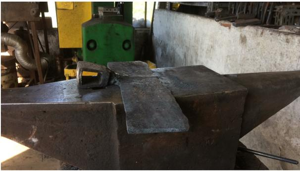
Figura 19: Una foto del manufatto durante la fase di forgiatura.
