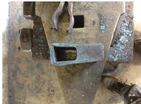
Figura 12: Particolare dell'occhio saldato.
