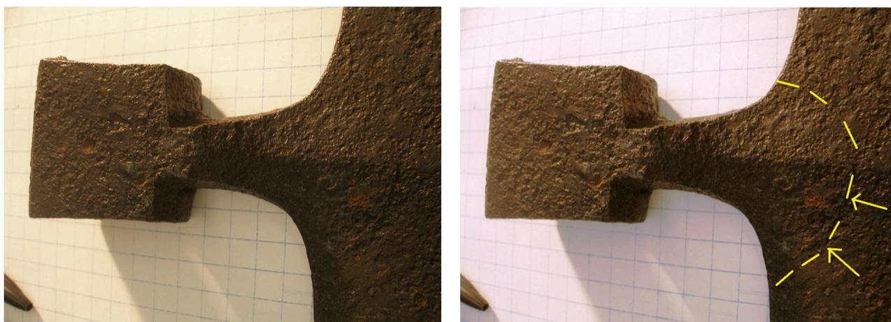
Figura 8: La probabile linea di saldatura tra lama e occhio individuata sulla superficie del reperto originale (Foto fornita dal sig. Cesare Paganini, su licenza della Fondazione FIORONI).
