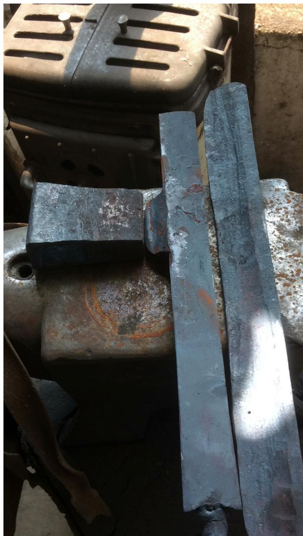
Figura 6: Sono qui visibili i tre componenti della scure: occhio (a sinistra), lama (al centro) e filo (a destra).
