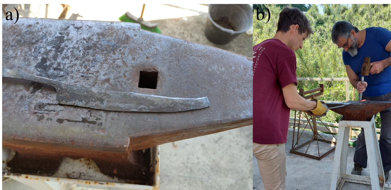
Figura 6: a) Incurvatura del dorso della lama in seguito alle operazioni di battitura a caldo del ferro (fotografia autore); b) Eliminazione della parte in eccesso dal dorso della lama tramite cesello. È necessario che il manufatto venga tenuto da un aiutante sull'incudine mentre il fabbro colpisce il cesello con il martello (fotografia autore).
