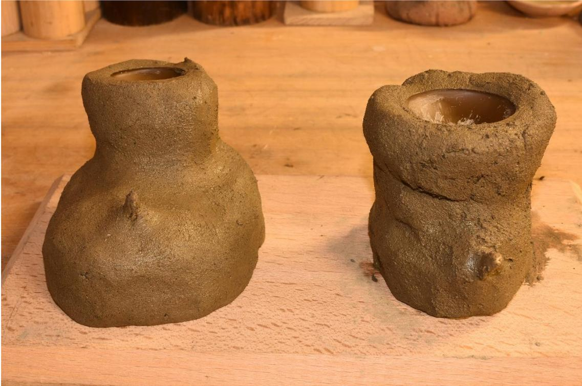
*Figura 10: Rivestimento con luto di tipo antico.*
