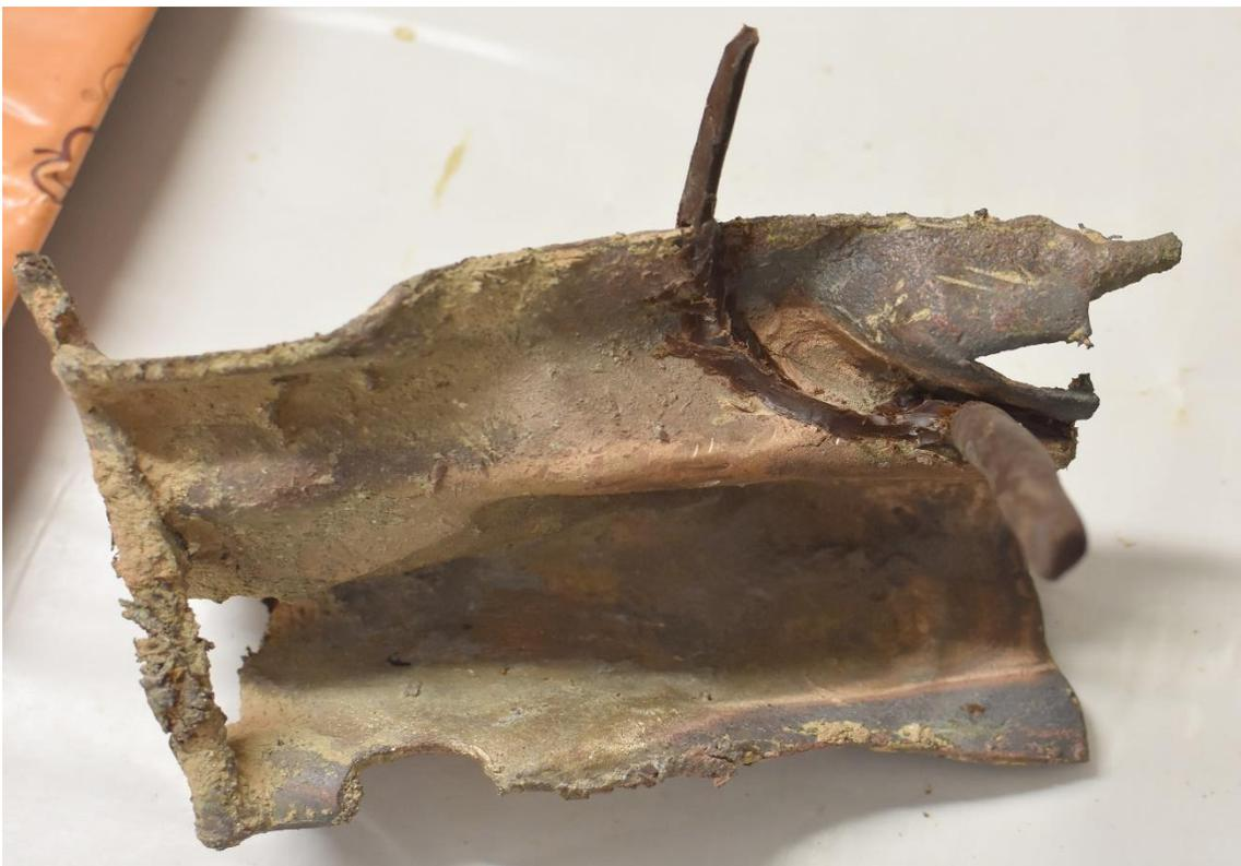
*Figura 19: Prova di saldatura per riparare la frattura.*
