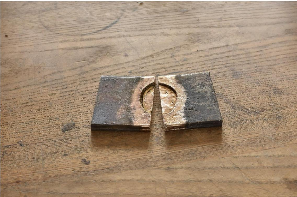
*Figura 7: Prova di saldatura a vaschetta.*
