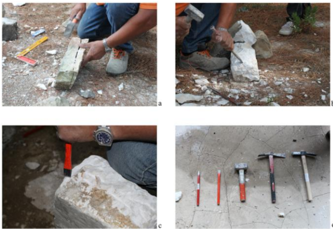
Figura 8: Tecniche di lavorazione della pietra e strumenti. a: spaccatura. b: sbazzatura. c: squadratura.
