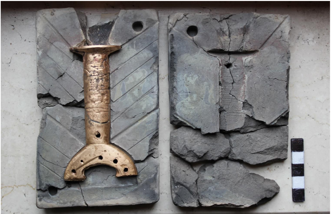
Figura 1: Riproduzione sperimentale del manico ad anima cava di un pugnale del ripostiglio di Ripatransone (AP), Bronzo Antico; il manufatto è realizzato con una fusione a cera persa in matrici bivalvi di argilla refrattaria.
