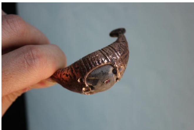
Figura 2: Prima fase della riparazione sperimentale di una fibula a "sanguisuga" caratterizzata da un ammanco di bronzo nella parte sommitale, causato da una bolla di gas. Attorno all'ammanco vengono praticati una serie di fori che diventeranno l'aggancio per la toppa ottenuta tramite fusione secondaria.
