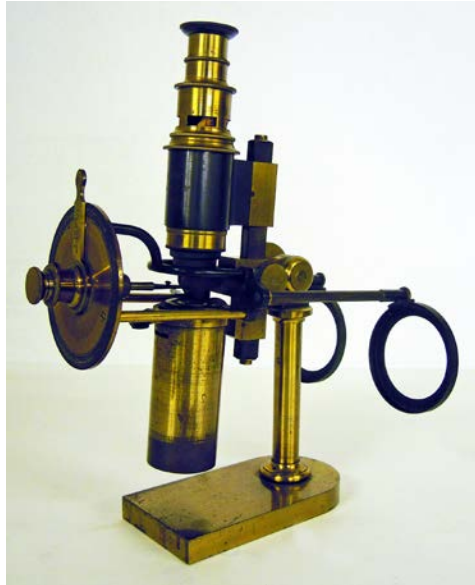
Fig. 2. Microscope polarisant utilisé par Des Cloizeaux (MNHN_IS_4260). 25 Reproduction autorisée.
